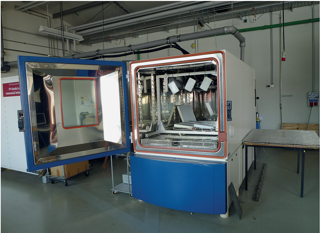
Bild 2: Prüfaufbau – Blick in die Klimakammer
